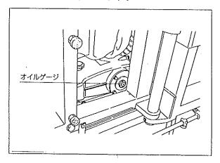
(ロ) クランクケースのシリンダ取付け部に ある3個の注油口に油差しでモビール 油(始業時毎)を、数滴注油します。
