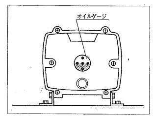
使用 オイル モビール油 SAE#30 容量1.15 Q 標準1/1/交換時間:初 回… 50時間目 2回目以降…100時間毎
