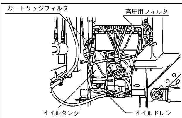
使用オイル 耐摩耗性油圧作動油 ISOVG32 容量 4L
