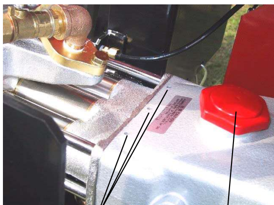
②噴霧用ポンプ シリンダ 元金具 ①噴霧用ポンプ クランクケース
